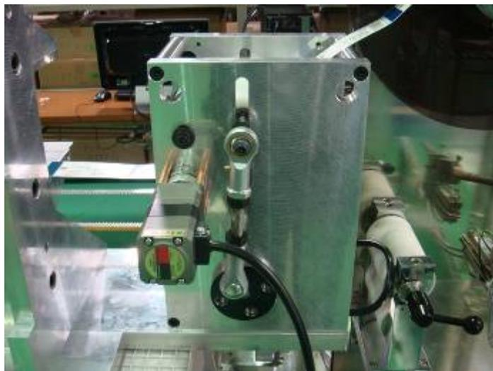
図10 印刷ラベル巻き取りモーター部拡大
