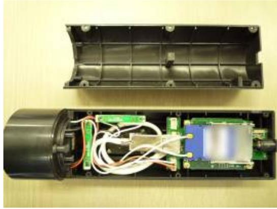
図 46 登録用、及び認証用読取カメラ装置内部
