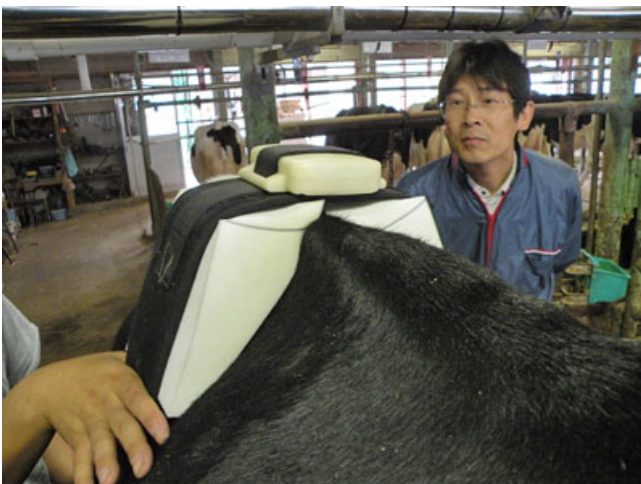
図 4-1-9-15 分割型 試作 2-3 セパレートタイプは、ずり落ちた場合、直接ベルトが背骨（棘突起）を圧迫する
