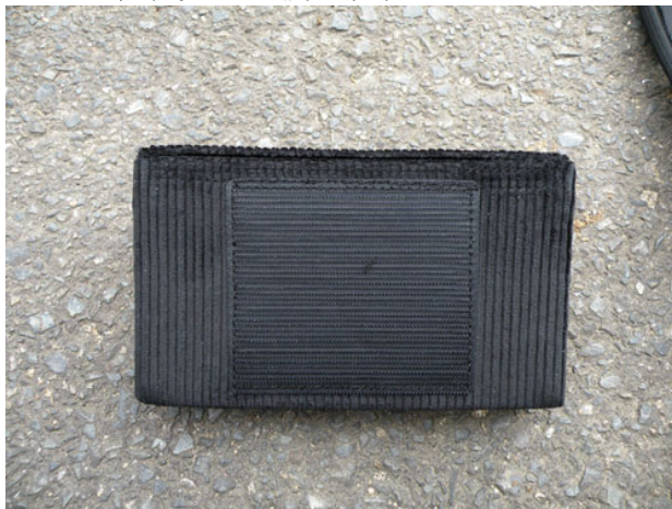
図 4-1-9-6 布パット試作 3 マジックの面を大きくした
