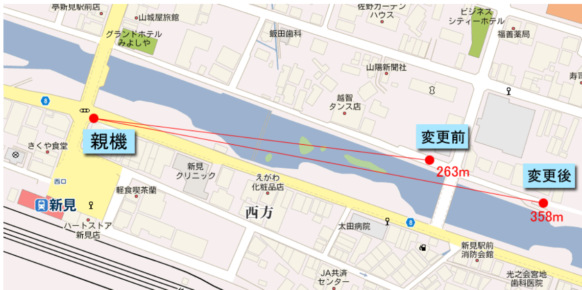
図 4-1-3-1 アンテナ変更前後の通信距離差
