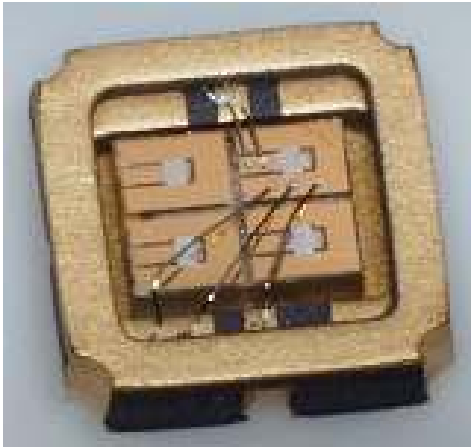
図 4-1a-7 可変キャパシタの実装状態とパッケージの外観
