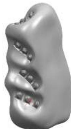
図4-3-3-2 左: 試作した片手文字入力システムのプロトタイプ概観。5本の指のキーの移動方向を、親指キーは母音発声時の顎の動きに、他の4本の指のキーは子音発声時の舌と唇動きに合わせて設定している。視覚および音声フィードバックを含む学習支援ソフトも開発した。 右: USB接続型装置の3次元形状モデル。
