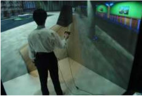
図 4-2-2-1 動的 3 次元環境下での自己の運動感覚を提示することができる運動予測学習法を開発するためのシステム。足首に装着したセンサによって障害物回避行動時の身体動作を記録・再生することができる。
