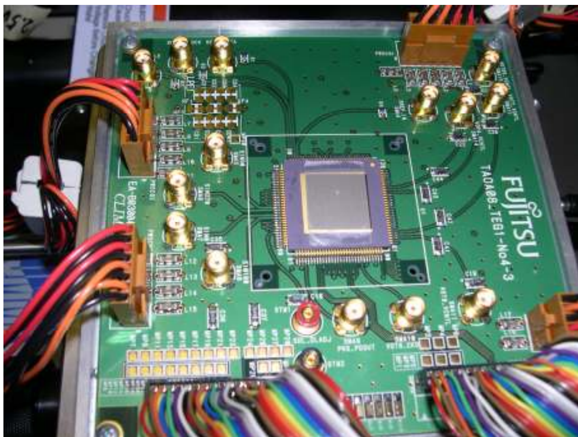
図 5－2－10 評価ボード写真（OSC用） OSC内にて使用する個別回路も評価可能
