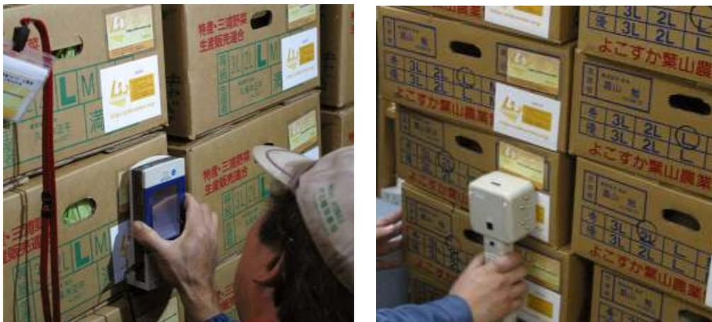
図 5-1-7 運搬用段ボール箱タグの読み取り（左：カード型、右：シール型）
