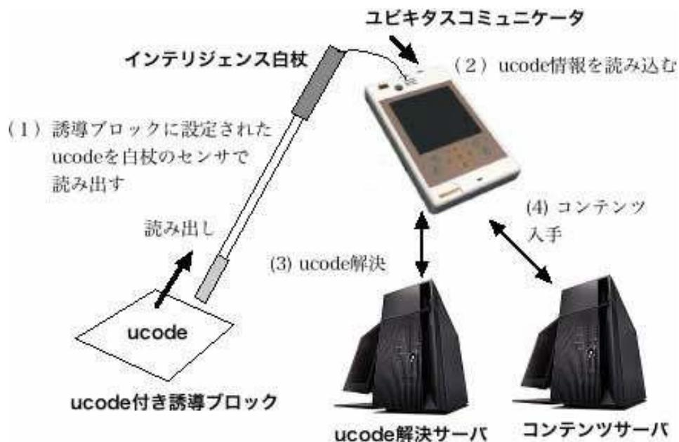
図 5-3-27 ユビキタスコミュニケーターと誘導ブロックを用いた ucode の処理
