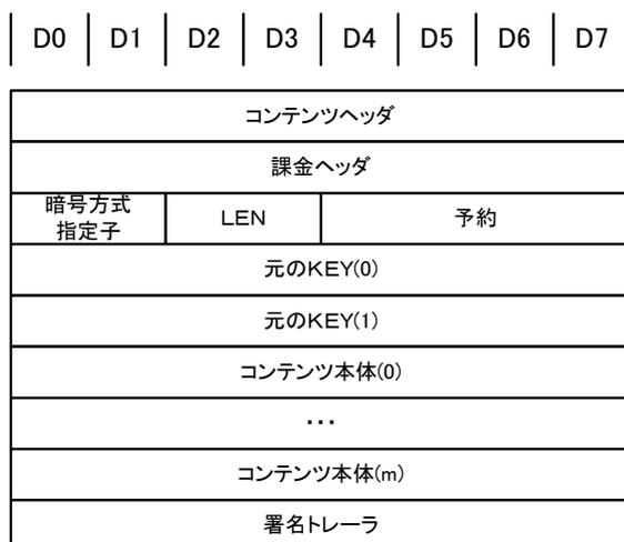
図 5-5-2 標準コンテンツ形式(暗号化前)
