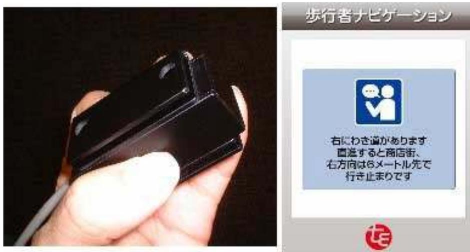
図 5-3-28 地磁気センサーと方角情報と ucode を利用したナビゲーション画面
