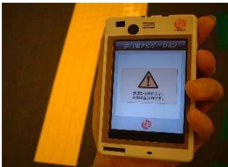
図 5-3-29 地磁気センサーによる方角情報と赤外線タグを利用したナビゲーション
