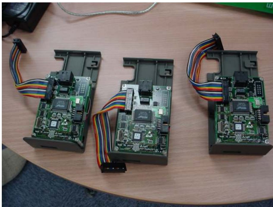
図 5. 2-12 センサ側に使用した \mu T-Engine
