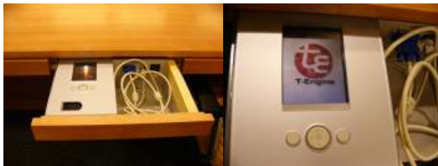
テーブルの手元を引き出すと、制御用のコンピュータと、各種入出力用のコネクタとケーブルが収容
