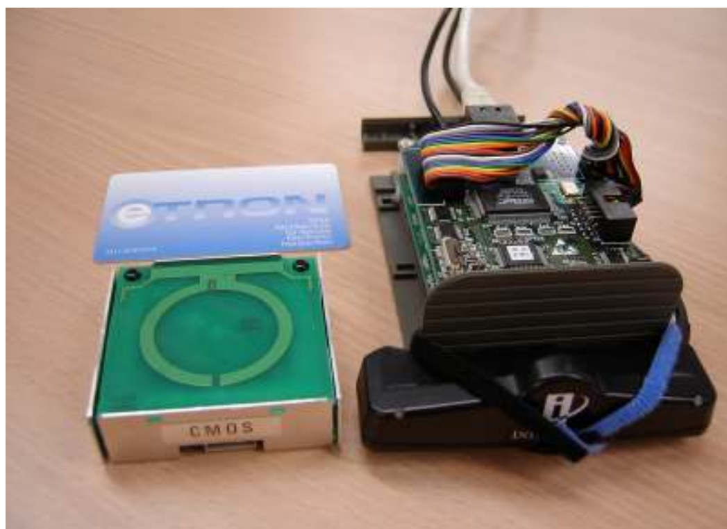
図 5.3-42 位置測定装置。右下についているのが超音波による屋内高精度測位装置のセンサ部分
