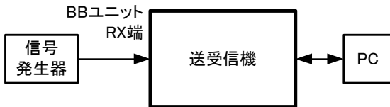
図 4-1-12 C/I による Eb/No 対 PER 測定系統図
