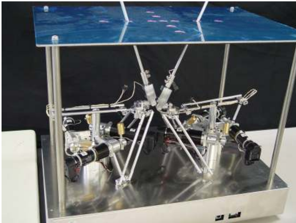
図 4-3-3 手術シミュレーション装置（模擬術具部）
