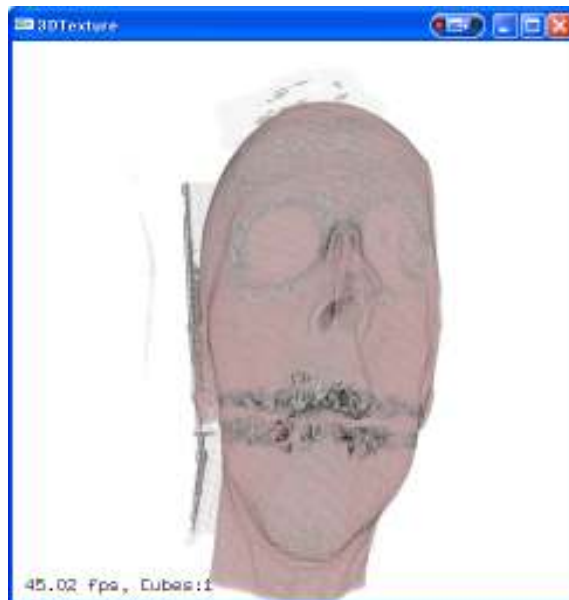
図 4-1-1 3次元テクスチャを使用したボリウムレンダリングによる表示例
