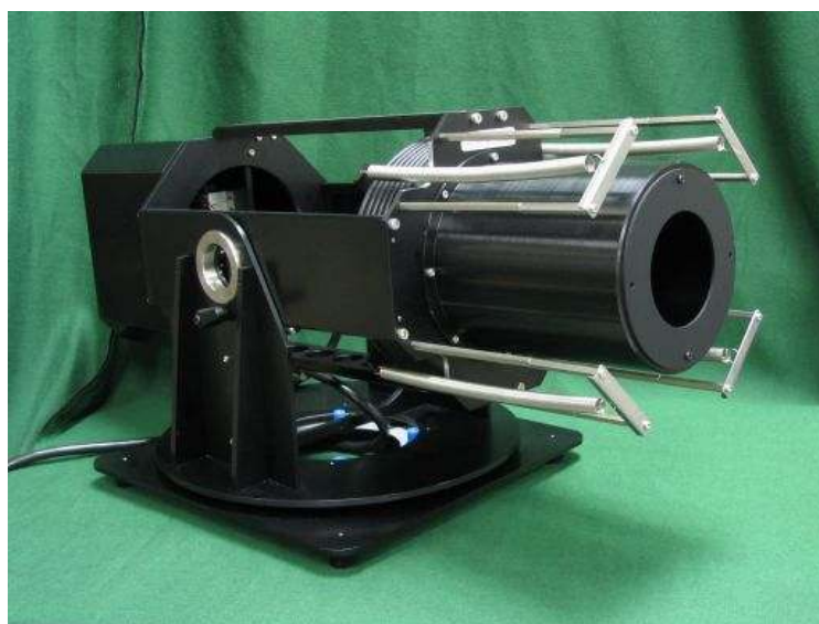
図4-2-3 空気砲を利用した刺激提示装置
